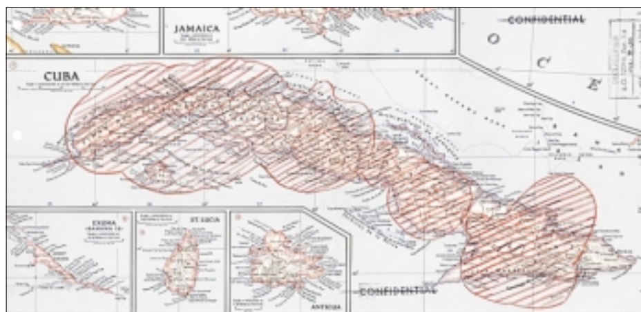
Aus dieser von der USIA für die CIA erarbeiteten Karte geht hervor, dass Fidel Castro den Empfang eines geplanten neuen 1000 kW-Mittelwellensenders fast auf der gesamten kubanischen Inseln hätte erheblich stören können (schraffierte Fläche).
