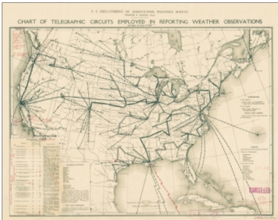
Karte des US-Wetterbüros von 1927. Sie zeigt die damals vorhandenen Funk- und Telegraphieverbindungen über die Wetterbeobachtungen gemeldet wurden. Die Funkverbindung von New Orleans nach Swan Island (ganz unten, rechts der Mitte) wurde von uns rot eingefärbt.
