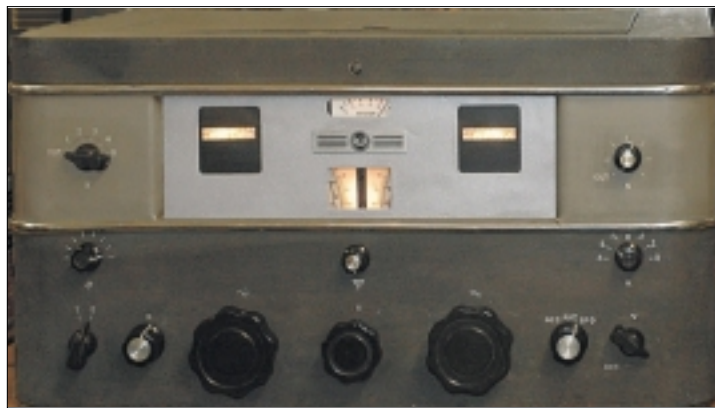
Links: Ab 1939 gebauter Hallicrafters HT-9 Sender. Durch auswechselbare Abstimmereinheiten konnte das 54 Kg schwere Gerät auf verschiedenen Wellenbereichen arbeiten. Das Gerät auf Swan war für den 14 MHz-Bereich eingerichtet. Sendeleistung CW 100 Watt, Sprache 75 Watt. Rechts: RCA Empfänger AR-77. Der durchgehende Frequenzbereich von 540 kHz bis 31 MHz war in sechs schaltbare Bereiche unterteilt.
