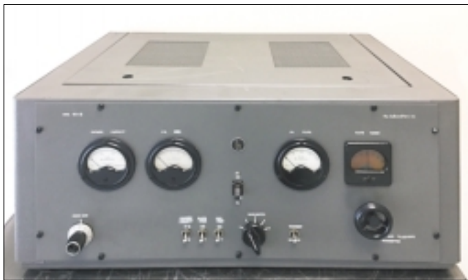
Links: Ab 1939 gebauter Hallicrafters HT-9 Sender. Durch auswechselbare Abstimmereinheiten konnte das 54 Kg schwere Gerät auf verschiedenen Wellenbereichen arbeiten. Das Gerät auf Swan war für den 14 MHz-Bereich eingerichtet. Sendeleistung CW 100 Watt, Sprache 75 Watt. Rechts: RCA Empfänger AR-77. Der durchgehende Frequenzbereich von 540 kHz bis 31 MHz war in sechs schaltbare Bereiche unterteilt.
