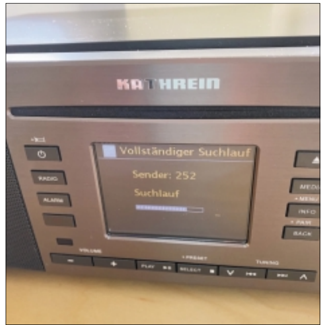
Der Suchlauf am Kathrein DAB+ Highline 100.
