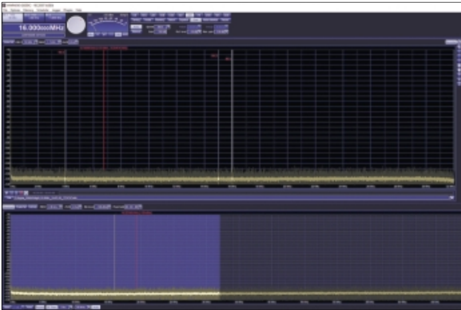
Bild 7: Am Dummy Load zeigt das hier als hochwertiger Spektrumanalyzer genutzte Winradio GR65DDC Sigma dieses Bild: perfekt zum Messen!
