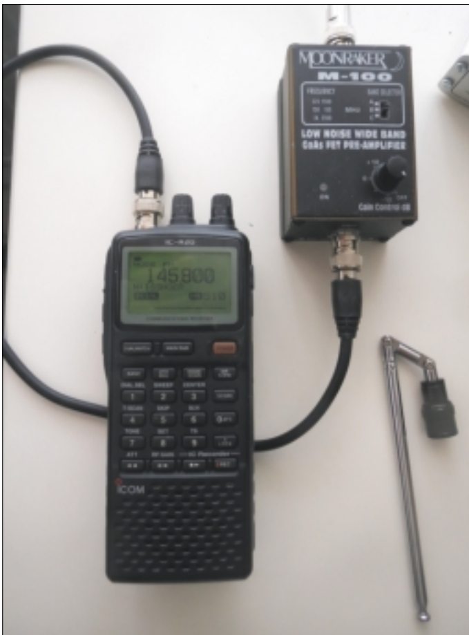
Bilder 1 und 2: Die Empfangstechnik: Handscanner ICOM R20, Signalverstärker Moonraker M-100 und Turnstyle-Antenne TA-1.
