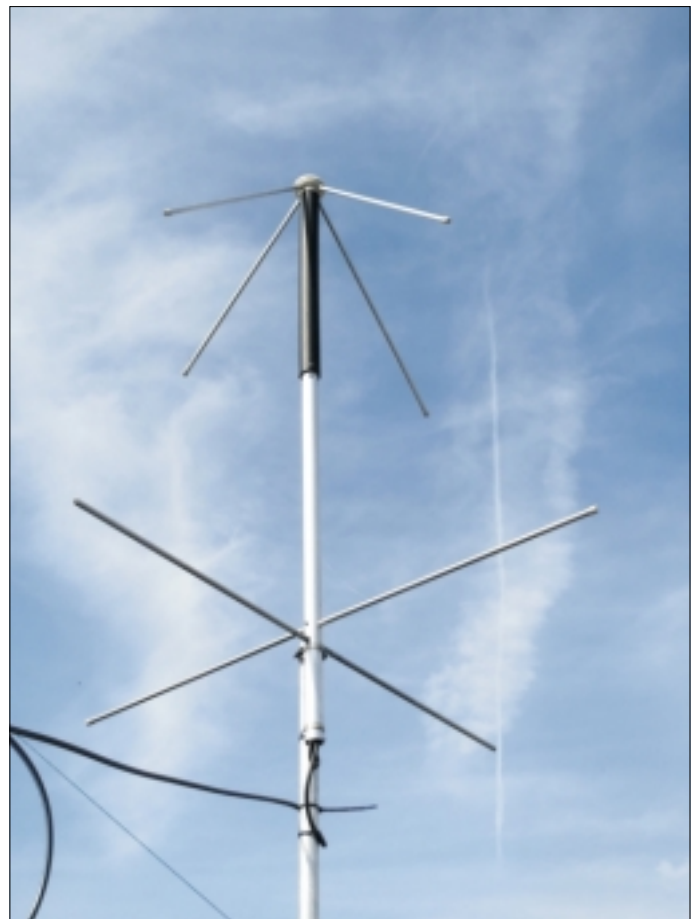
Bilder 1 und 2: Die Empfangstechnik: Handscanner ICOM R20, Signalverstärker Moonraker M-100 und Turnstyle-Antenne TA-1.
