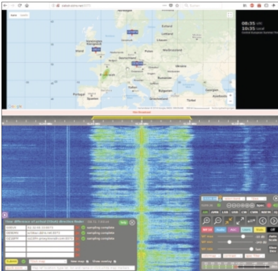
Bild 7: Die Peilung auf 15.320 kHz fördert in der „TDoA map“ oben dessen Position im Mittelwesten Frankreichs zutage.
