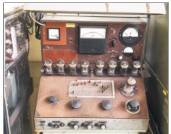
Röhren-Prüfgerät; die acht Röhren in der oberen Reihe wurden vorgeheizt, bevor an der zu prüfenden Röhre darunter Ströme und Spannungen gemessen wurden; der hier geprüfte Röhrentyp SRS551 ist eine Sende-Pentode für UKW.
