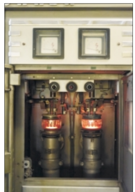
Endstufe des Kurzwellensenders von 1951. Foto: DLR, Bettina Straub.
