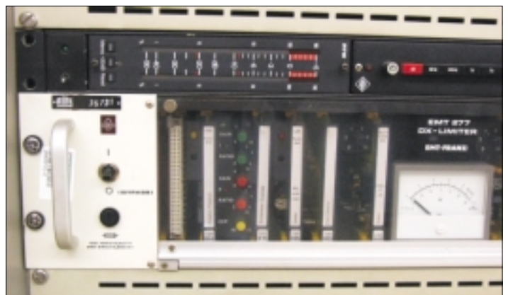
Ebenfalls noch mit RIAS -Inventarnummer: Einer der Dynamikkompressoren, die bis zu ihrer Ablösung durch digitale Geräte den Mittel- und Kurzwellensendern in Berlin-Britz vorgeschaltet waren.
