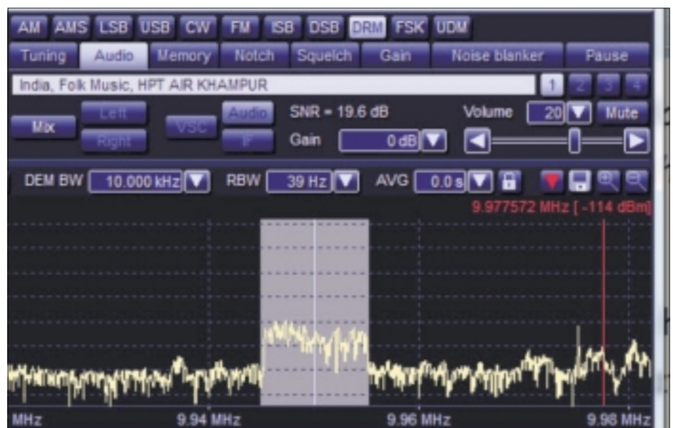
Abbildung 8: Mit dem integrierten Fraunhofer-DRM-Decoder (Option) drückt man einfach auf die Taste „DRM“ (oben) und – in diesem Fall – All India Radio auf 9950 kHz klingt aus dem Lautsprecher. Der Sender wird in der Zeile oben mit seinem Namen angezeigt, darunter ist zudem der Signal-Rauschabstand mit 19,6 dB abzulesen.
