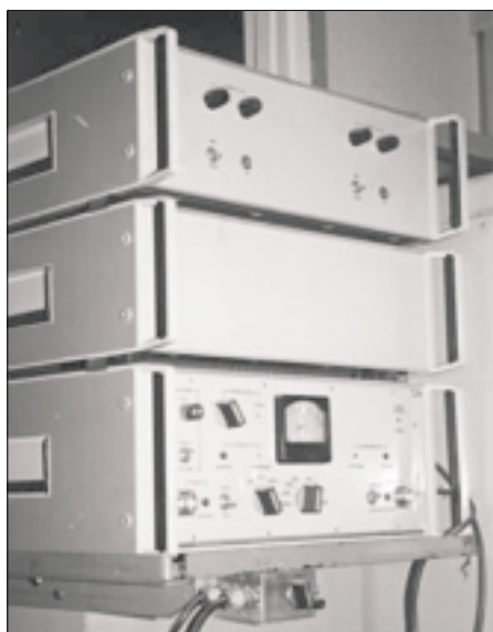
Abbildung 12: Jamming- Modulator Zenit-M für die Mittelwelle in Sitkunai.
