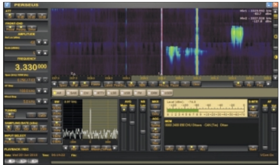
Abbildung 6: Marker 1 erfasst den Pegel des Trägers, Marker 2 den Rauschpegel, der später noch um +8,83 dB zu korrigieren ist- entsprechend 7,63 Hz Auflösungsbandbreite. Datensignal rechts außen sowie Zeitansage wurden ebenso wenig berücksichtigt wie die eigentlichen Zeitzeichen dazwischen. Eine Glättungsfunktion (AVG) macht die Anzeige ruhiger.
