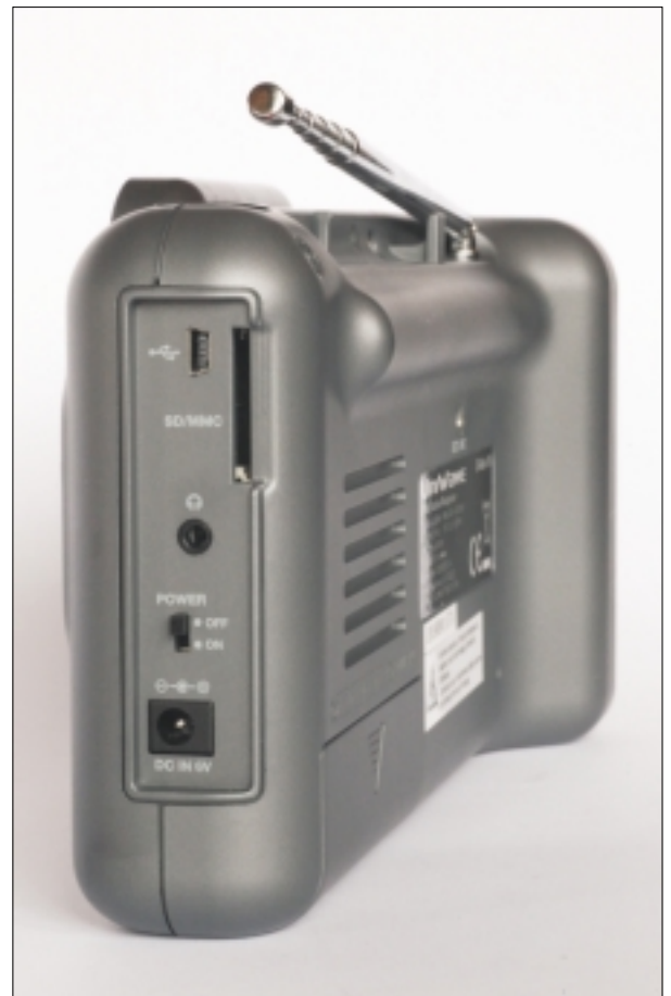
Das seitliche Anschlussfeld bietet auch einen Steckplatz für Speicherkarten.
