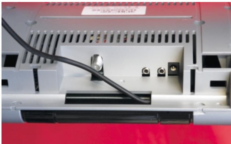
*Ein Blick auf die schwer zugängliche Anschlussleiste auf der Rückseite des Empfängers. Bei abgenommener Ferritantenne sind die Buchsen leicht zugänglich. Allerdings stören die Kabel, wenn man den Empfänger auf den separaten Halter setzt.*
