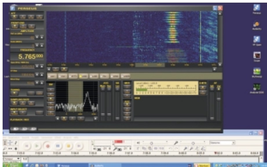
Abbildung 2: AFN Guam kommt auf 5.765 gut herein. Unten der kostenlose Audio-Recorder 'Audacity' [2], mit dem man die demodulierten Signale speichern kann.
