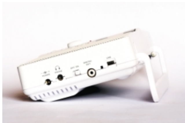
Auf der rechten Gehäusesseite liegen die Anschlussbuchsen, einschließlich eines digitalen Audioausgangs.
