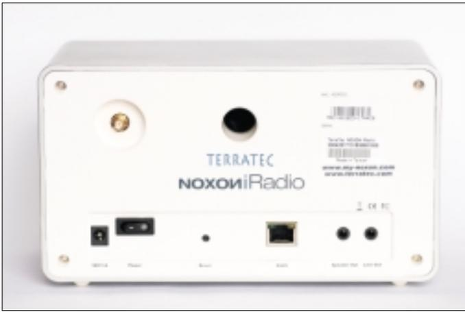
Die Webweltempfänger der Noxon-Familie halten per WLAN oder Ethernet Kontakt zum Netzwerk. Funkantenne und Netzwerkkabel lassen sich beim iRadio auf der Rückseite anschließen.
