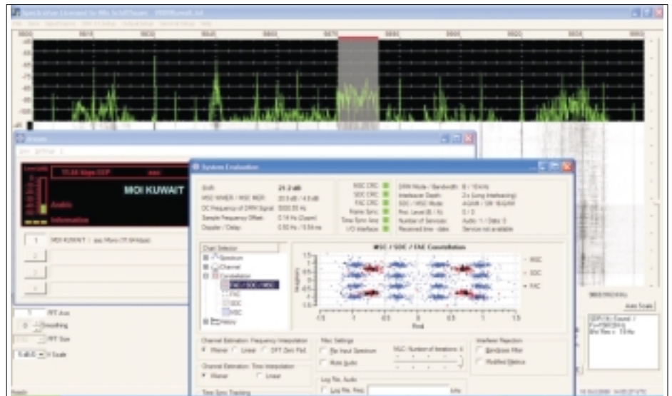
Abbildung 13: Die Kunst zeigt sich auch in der Beschränkung. Radio Kuwait/Sulaibiyah auf 9880 kHz sendet für Afrika nicht in 64-QAM, sondern im robusteren 16-QAM. Das ergibt sogar in Europa trotz nicht gerade starken Signals noch eine gute Trennung der einzelnen QAM-'Kanäle'.
