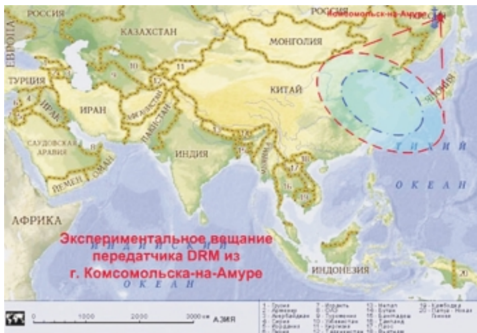
Ausleuchtzone des neuen russischen DRM-Senders in Komsomolsk-on-Amur (Typ PKV-250, Spitzenleistung 250 kW). Es wird seit 1. Januar 2007 von 02:00 bis 06:00 Uhr auf 15.640 kHz das Programm von 'Voice of Russia' gesendet.
