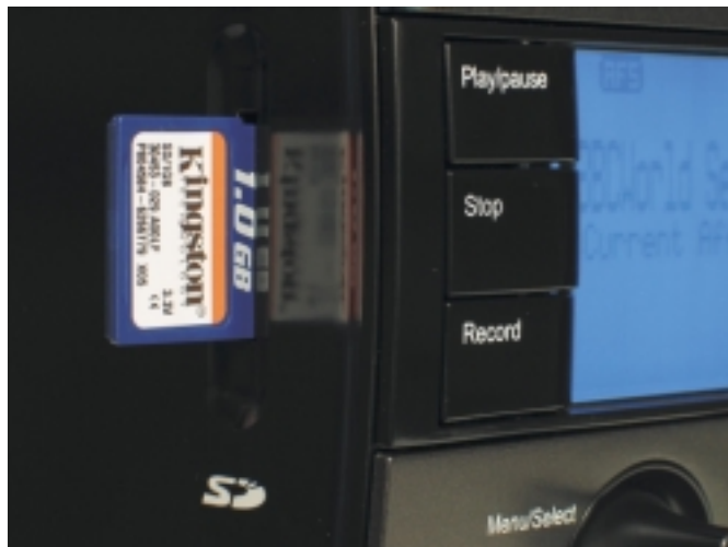
Der Empfänger speichert digitale Hörfunksendungen auf bis zu 2 GB fassenden Speicherkarten.
