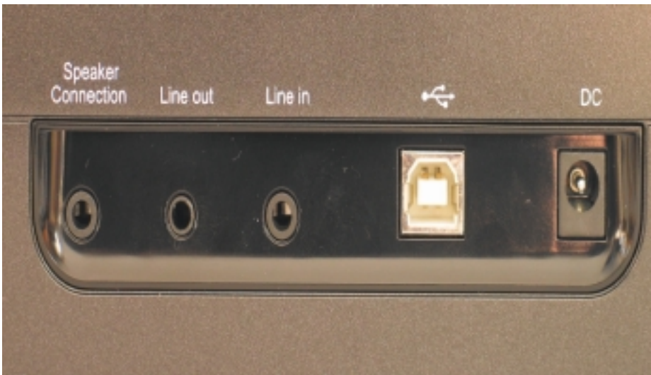
Ein Blick auf das rückwärtige Anschlussfeld des Morphy Richards.
