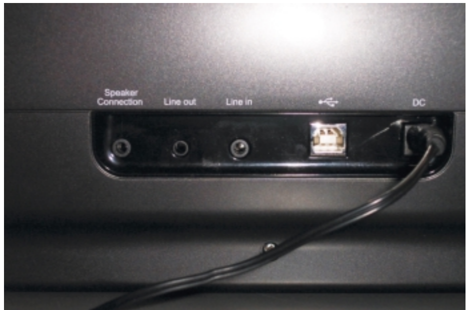
Die Anschlussmöglichkeiten des Morphy Richards: Externer Lautsprecher, Line in, Line out, USB-Schnittstelle und Eingang für die Versorgungsspannung.
