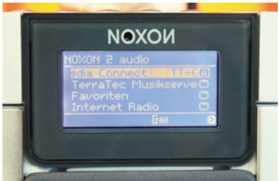
Der gewünschte Internet-Sender lässt sich bei allen Noxon-Empfängern per Drucktasten übers Bedienmenü auf dem Display wählen
