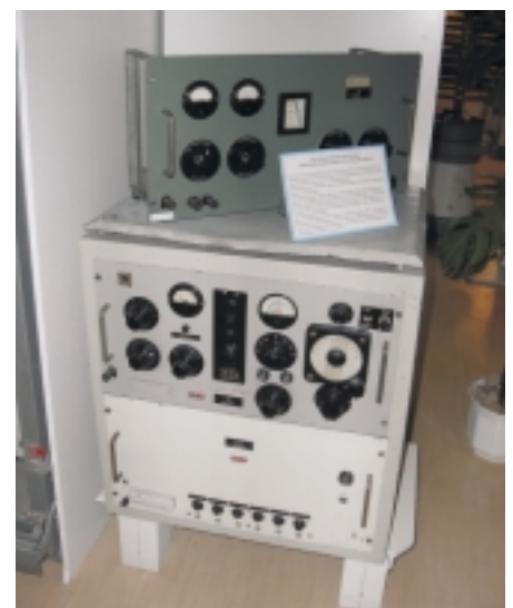
Mittelwellen-Kleinsender aus den 50er Jahren, als Störsender gegen RIAS Berlin eingesetzt. Foto: Kai Ludwig.
