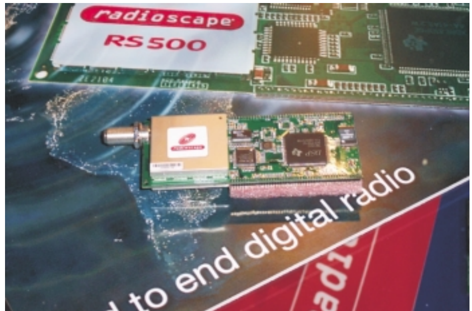
Die Empfangseinheit RS500 von RadioScape decodiert LW, MW und KW analog und digital (DRM) sowie UKW mit RDS und DAB
