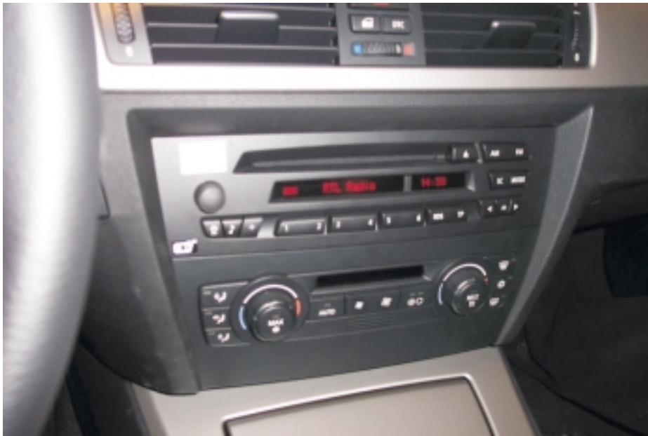
DRM/DAB-Autoradio von Visteon auf der IFA 2005 (Prototyp).
