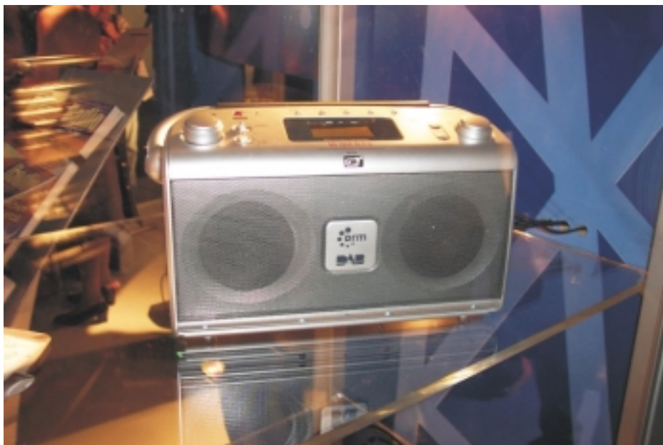
Der Roberts RD 70 empfängt LW, MW und KW analog und digital (DRM), UKW mit RDS und DAB. Er soll um die Jahreswende 2005/06 in den Handel kommen.
