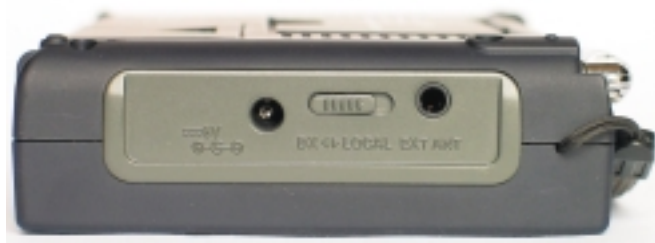
Auf der linken Geräteseite liegen Anschlussbuchsen für externe Stromversorgung (6 Volt) und Außenantenne
