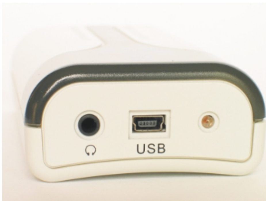
Für die Verbindung zwischen Empfangsbox und Computer sorgt ein USB-Schnittstellenkabel
