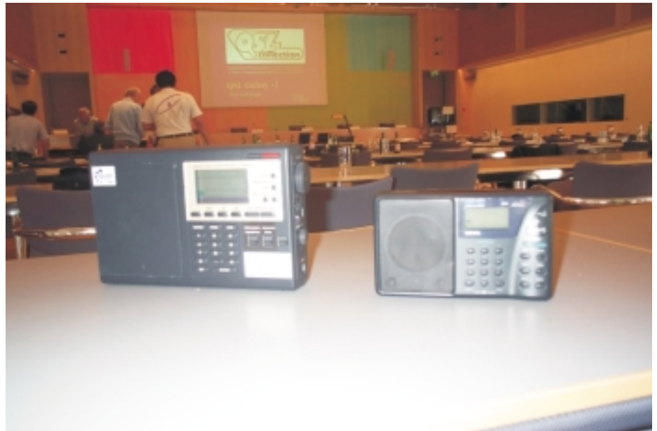
DRM-Empfänger der ersten und der zweiten Generation: links der erste Stand Alone Empfänger von Coding Technologies, rechts der ab Dezember 2003 lieferbare Mayah 2010
