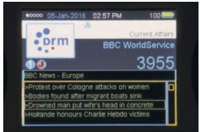
Das Farbdisplay des Avion zeigt auch per DRM im Journaline-Standard übertragene Kurznachrichten an; hier vom BBC World Service auf 3955 kHz.
