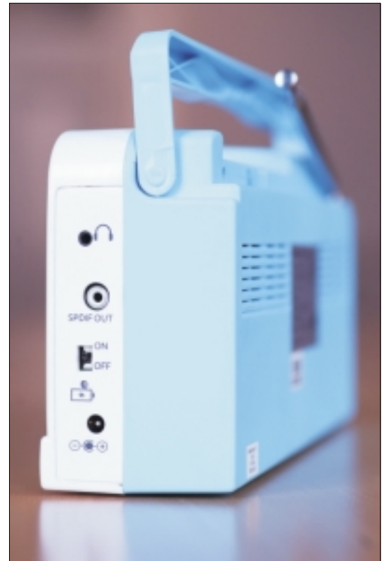
Anschlussbuchsen auf der rechten Geräteseite: Kopfhörer, Digital-Audio, Stromversorgung. Eine LED zeigt den Ladestand des eingebauten Akkumulators an.
