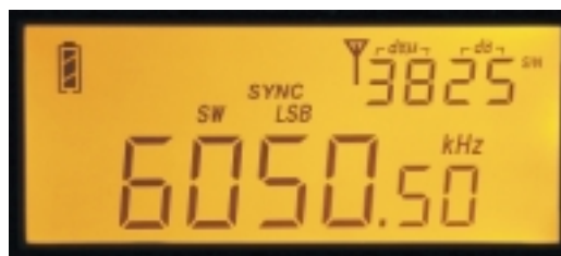
Bei aktiviertem Synchrondetektor erscheint im Display des PL-880 der Schriftzug SYNCH , ergänzt durch das momentan gewählte Seitenband.
