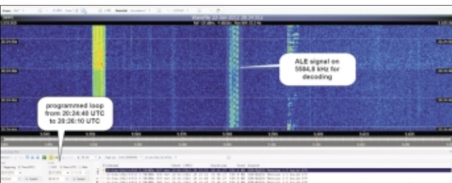
Abbildung 9: Hier habe ich einen ALE-Kanal herausgepickt und die Software SDR-Radio des SDR-IP so programmiert, dass sie genau diesen Teil zwischen 20:24:40 und 20:26:10 UTC laufend abspielt.
