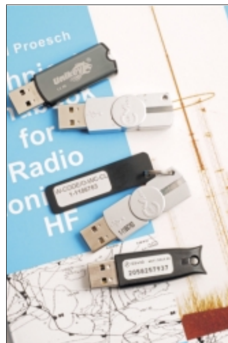
Abbildung 1: Schlüssel zur Software ist ein USB-Dongle – hier die von Krypto500, Code3-32P, W-Code und GX430 (von oben nach unten).
