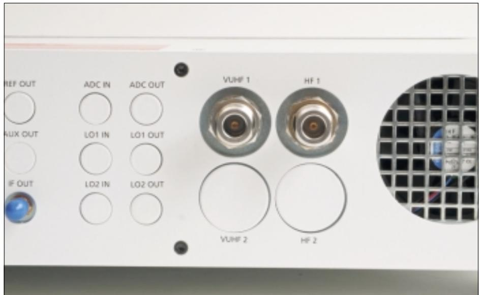
Die Antennenanschlüsse sind in N-Norm ausgeführt, hier die Außenansicht ...
