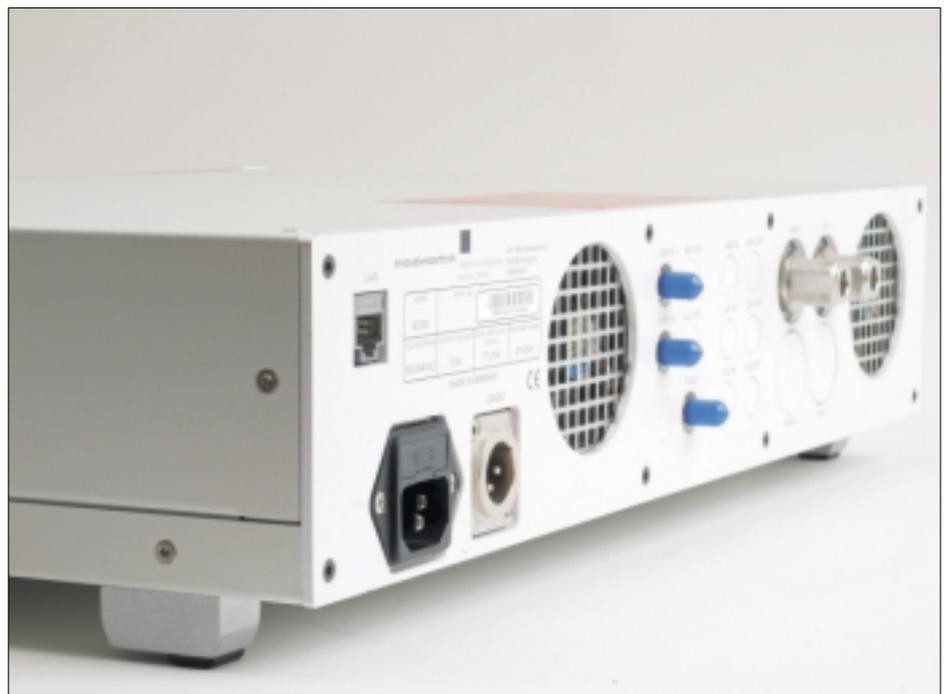
Die Rückseite wird beherrscht von zwei Gittern der gut hörbaren Lüfter sowie Anschlüssen für LAN, Versorgungsspannung, Antennen und Weiteres.
