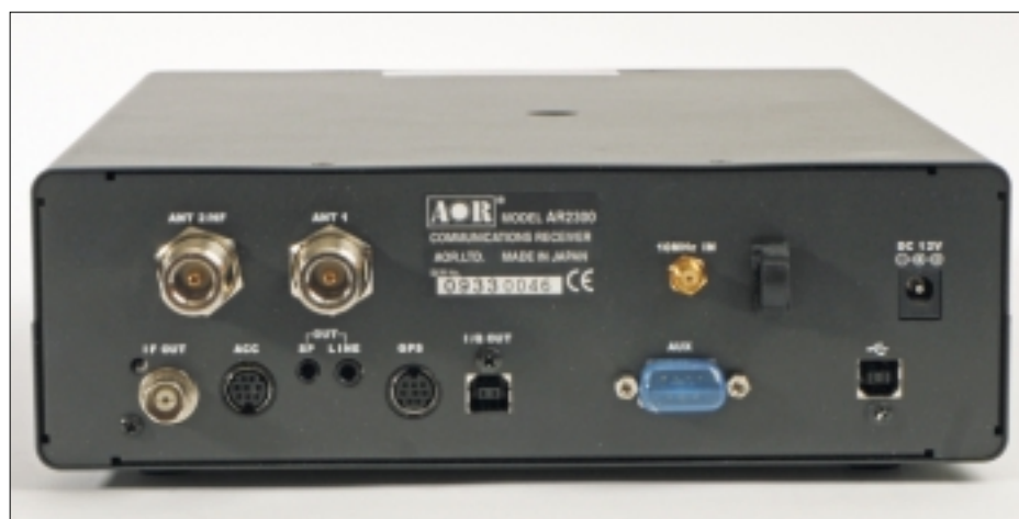
Zwei N-Antennenanschlüsse befinden sich auf der Rückseite sowie weitere Buchsen, wie die für einen zusätzlichen 10-MHz-Standard zur GPS-Stabilisierung der Frequenz.
