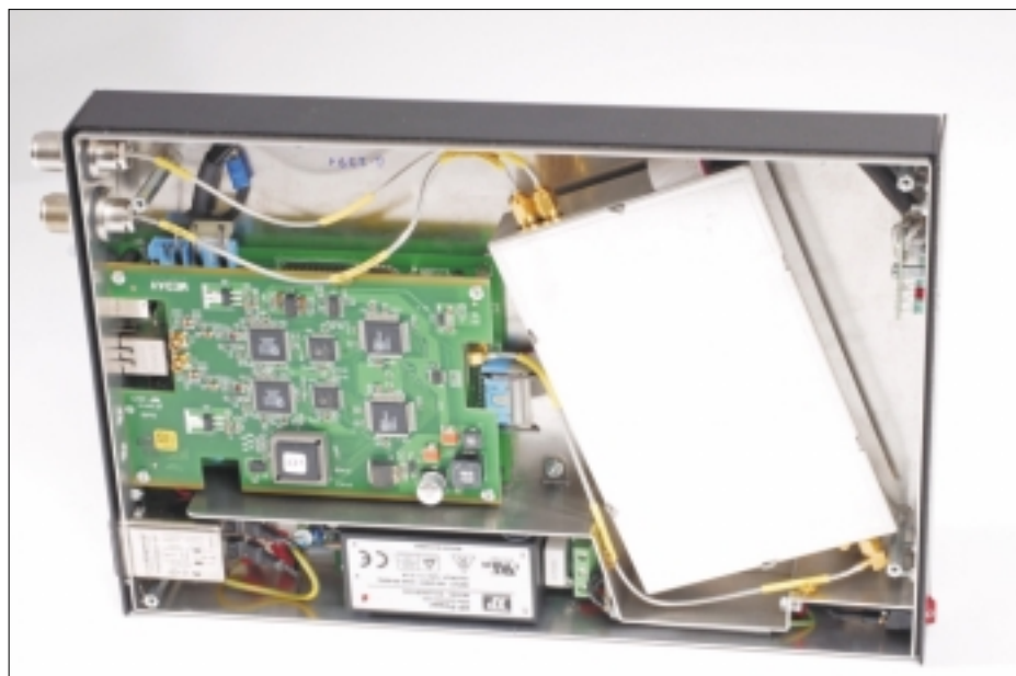
Schraubt man den Gehäusedeckel ab, so bietet sich dieser Anblick. Unter dem Abschirmblech des wegen Schutz vor Kopplungen schräg eingesetzten Eingangsmoduls verbirgt sich unter anderem der Preselektor.
