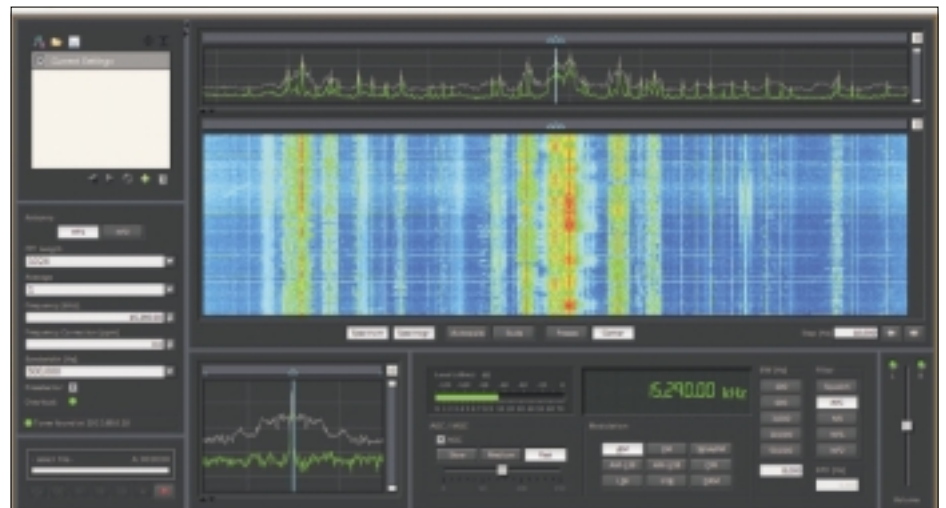
Via LAN sind bis zu 500 kHz mit einem Blick überschaubar – wie hier im 19-m-Rundfunkband.
