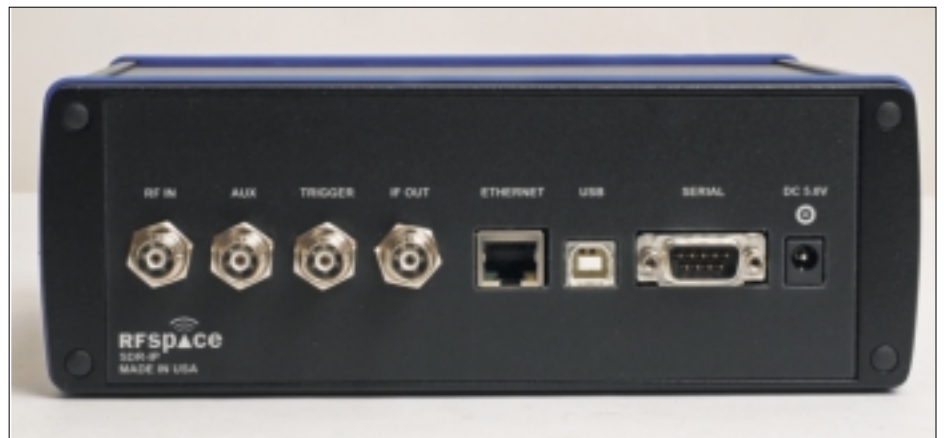
Auf der Rückseite fallen USB- und LAN-Anschluss sowie verschiedene BNC-Buchsen auf, über die auch ein Synchronisationssignal einzuspeisen ist.
