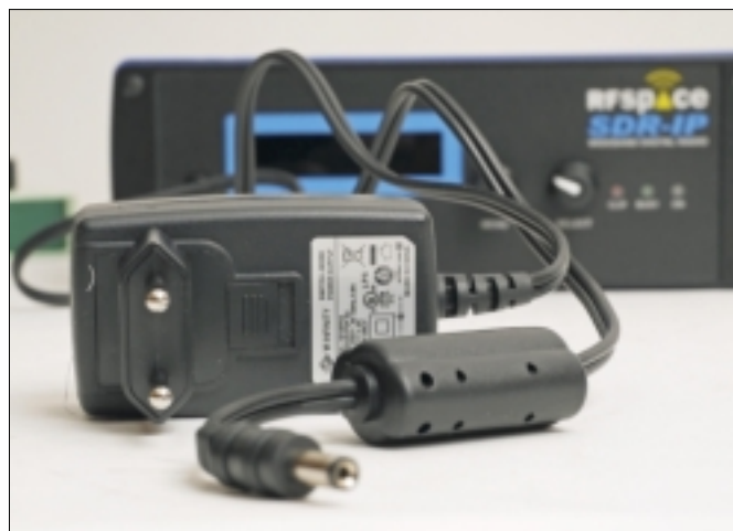
Ein auch für 220 Volt Netzspannung geeignetes Schaltteil wird mitgeliefert. Man beachte auch die große Drosselspule, die Störungen vom Empfänger fernhält.
